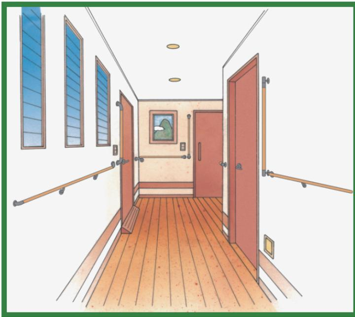
改修例1) 廊下と居室の段差をなくして、床材変更により車椅子でもスムーズな移動を実現
