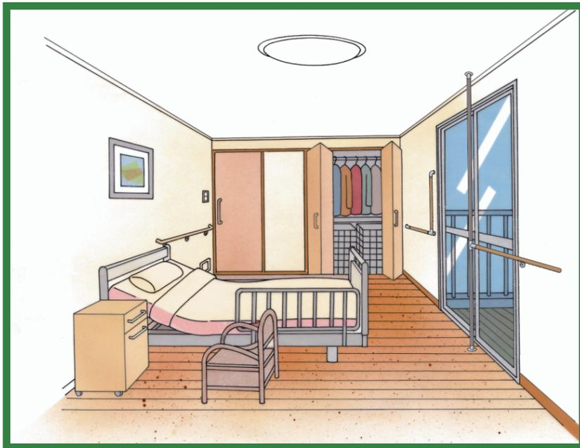
改修例1) 畳からフローリングに変更して車いす移動しやすくなる
